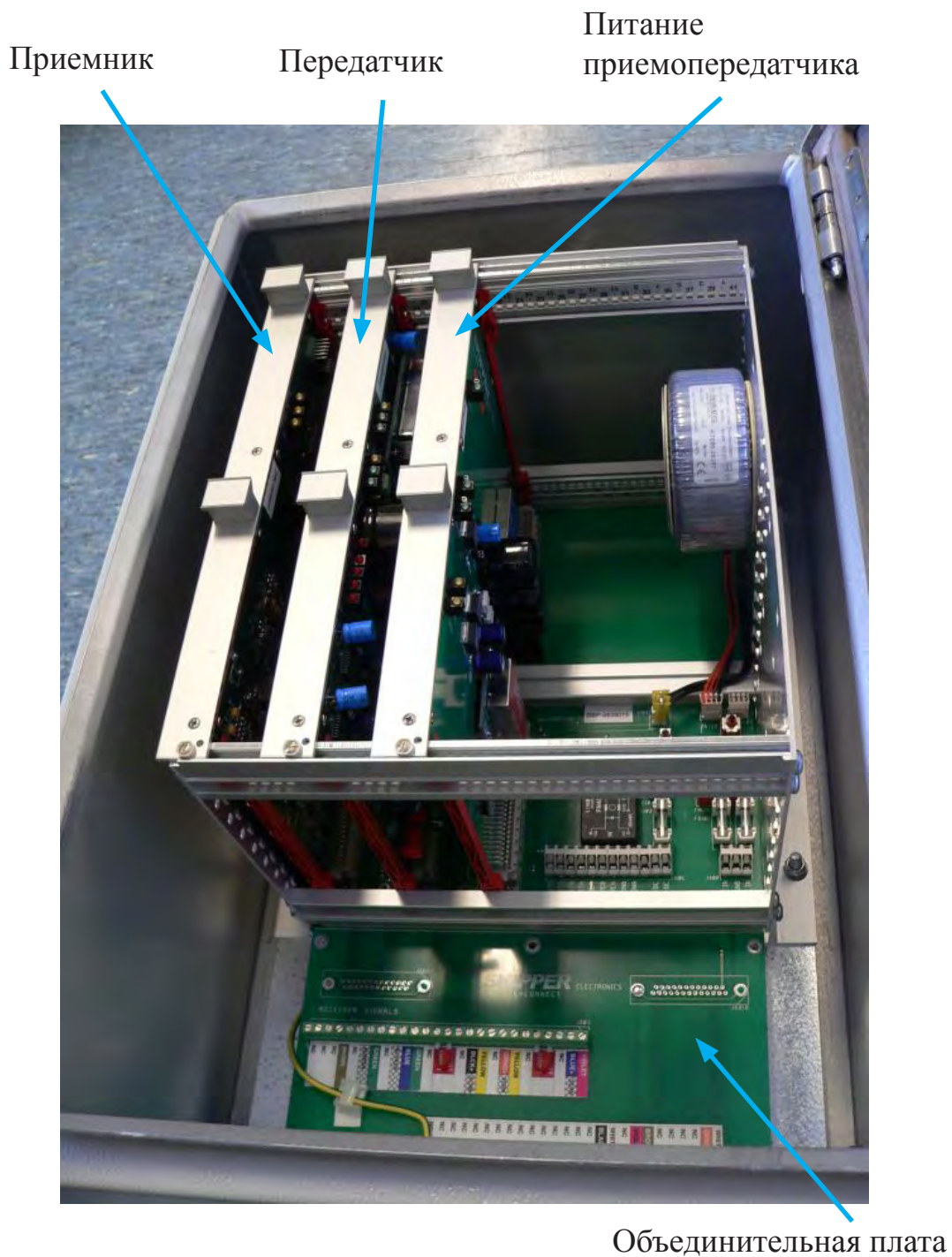
Рис. 10.1 Положения плат в приемопередатчике
