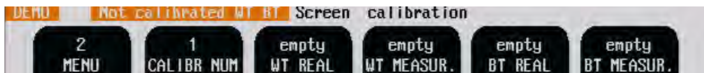
Экран «Калибровка», Меню 2, ручной ввод максимальных параметров.
